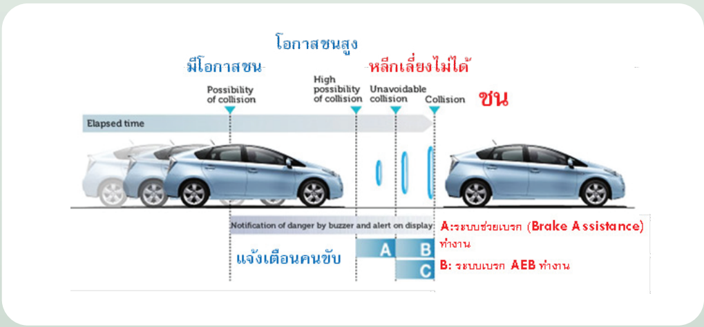
รูปที่ 5 การทำงานของ Autonomous Emergency Brake (AEB) [5]
