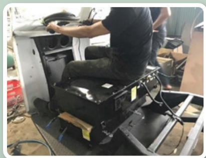
ติดตั้งมอเตอร์ที่ก่อนที่สอ
