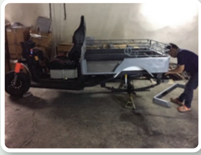
ติดตั้งกระบะ
