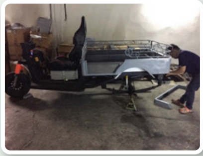
ติดตั้งกระบะ
