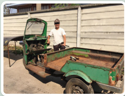
ถอดชิ้นส่วนหลังคาออก เพื่อตรวจสอบสภาพ
